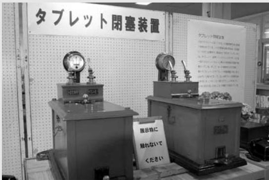
▲タブレット閉塞装置。簡単に言うと、列車を事故なく離合させるための装置。これは実際に使われている装置の予備機で、マニアにはたまらない逸品だそうです。
