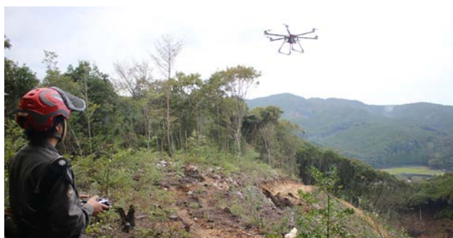
▲ ドローンを使い、シカの食害防護柵の材料を運搬
